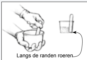
Figuur 3 Hars en verharder grondig roeren gedurende 2 minuten, bij lage temperaturen langer.
