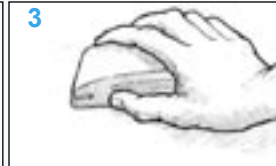
Figuur 8 Schuur niet-poreuze oppervlakken grof op. Zorg voor een structuur waaraan de epoxy zich kan hechten.
