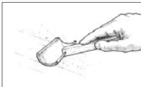
Figuur 31 Strijk de coating af door met een schuimkwast licht over de verse epoxy te gaan.
