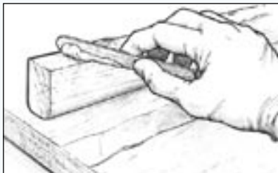
Figuur 10 Breng een laag verdikte epoxy aan op één van de delen die verlijmd worden.
